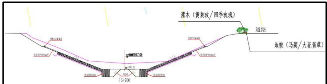
图 11.生态隔离带（单侧灌木+地被）断面图
